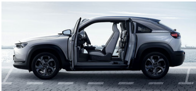
Portes « Freestyle » avec angle d'ouverture de 82°
